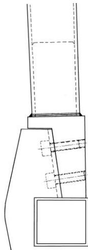
La nouvelle pièce de fixation de l'arceau principal devra être en appui sur le tube carré de 50x50 du châssis, et fixé par les 2 vis.
