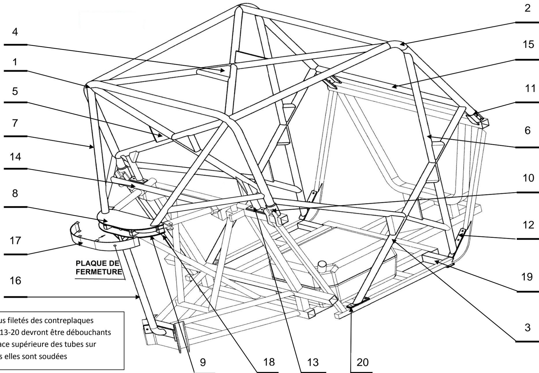
Tous les éléments constituant cette armature de sécurité doivent être conformes à l'article 283.8 de la FFSA (dimensions des tubes, goussets, etc...), à l'exception de la fixation des différents éléments de l'armature sur le châssis qui devront respecter ce plan. Attention au niveau de la jonction entre les croix de porte et du renfort de montant de pare-brise, c'est le renfort de montant de pare-brise qui doit être coupé, les croix de porte doivent rester entières
