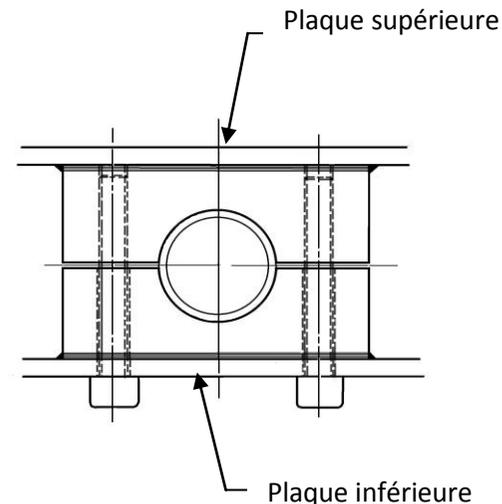
Les ½ coquilles devront avoir une largeur minimale de 30mm pour les 2 latérales et de 20mm pour les 2 arrières, et seront soudées sur la plaque supérieure et la plaque inférieure. L'assemblage se fera par 2 vis M8. Si les goussets existants gênent la mise en place des ½ coquilles arrières, ils devront être légèrement retouchés
